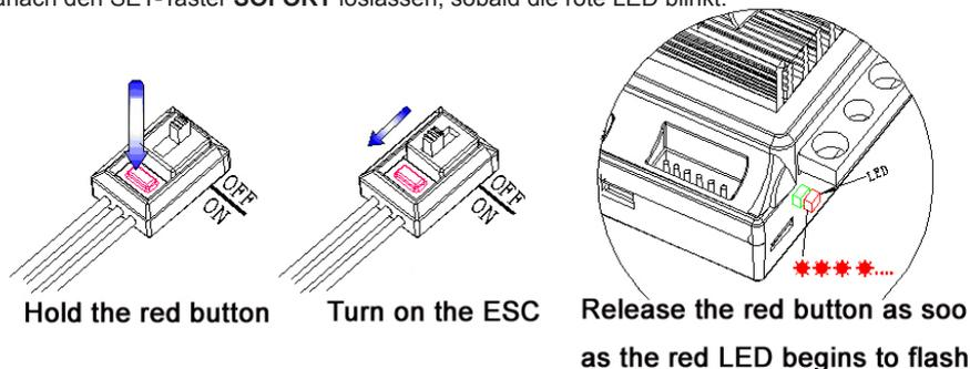
**Hinweis:** Wird der SET-Taster zu lange gehalten, gelangt man in den Programmiermodus des Reglers. In diesem Falle den Taster loslassen und die Schritte A) bis D) erneut ausführen.
